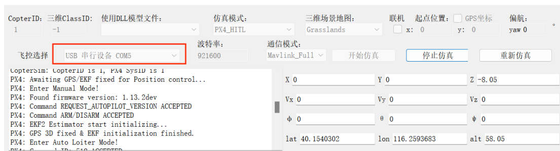
图 8 CopterSim 连接飞控串口信息
