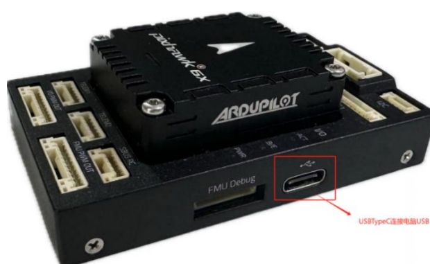
图 6 飞控 USB 口示意图（Pixhawk 6x 为例）
